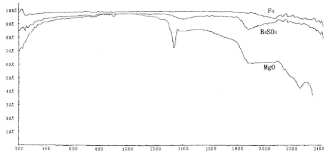
图 3 积分球不同涂层反射率光谱图
